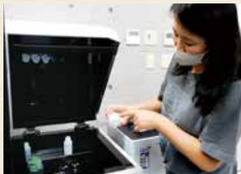
写真左:全国から届いた海水や水道水のボトル。測定し、海洋放出後のデータと比較する。ラボには何本ものボトルがあちこちに 写真右:海水などを分析する測定器、「液体シンチレーションカウンター」
