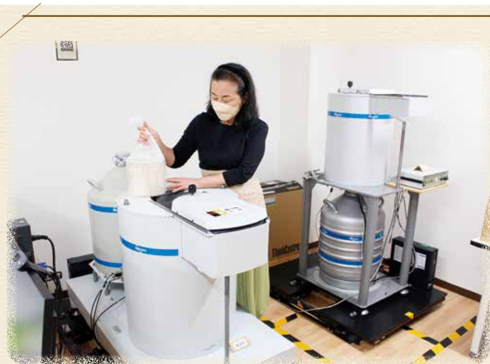
粉ミルクの放射能を測定する伏屋さん。市民が私財を投じて購入した測定機「ゲルマニウム半導体検出器」は、高精度な放射能(ガンマ線)測定が可能。自然界にある放射性物質の誤検出も少ない
